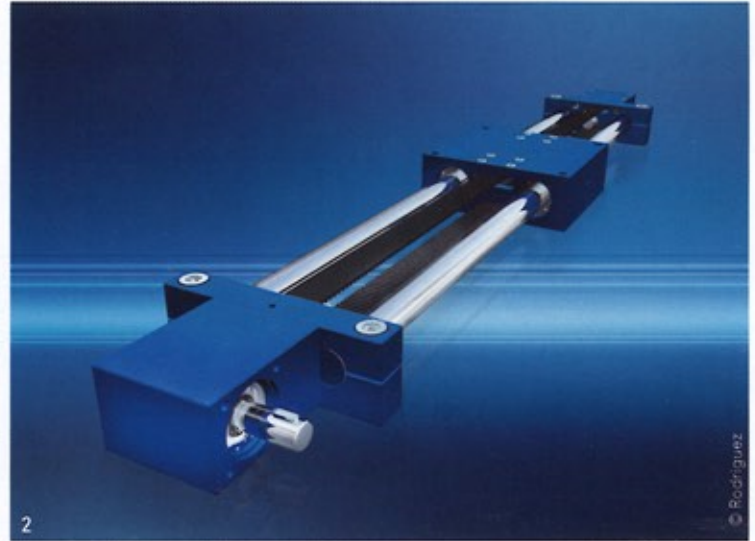
1 Kugelgewindetriebe besitzen einen sehr hohen Wirkungsgrad und werden daher typischerweise für dynamische Positionieraufgaben im Dauerbetrieb eingesetzt. 2 Die Kombination aus angepasster Kugelgewindemutter, Axial-Schräggugellager und Präzisionsnutmutter ergibt eine leistungsfähige, zahnrinnengetriebene Einheit.
