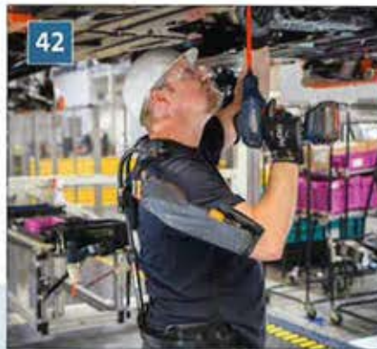
Schwebefeffekt: Exoskelett mit Kunststoff-Gleitlagern hilft, die Ermüdung bei langer Arbeit zu verringern
