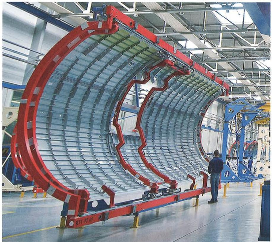
▲ Über die in den Boden der Produktionshalle eingelassenen Kreuztische können die zu montierenden Flugzeugteile millimetergenau zueinander positioniert werden. (Bild: Premium Aerotec GmbH)
