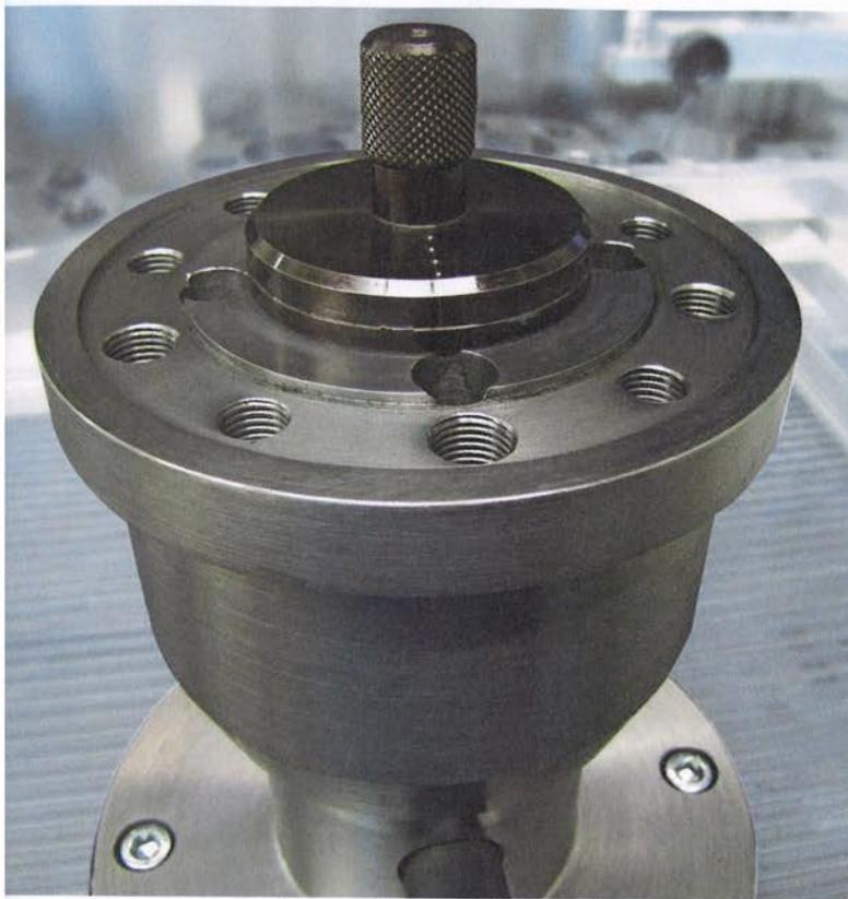
Die Rotationseinheit ermöglicht es, die Brems-scheiben an einem der Felge nachempfundenen Radersatzstück zu befestigen und anschließend berührungslos zu vermessen.
