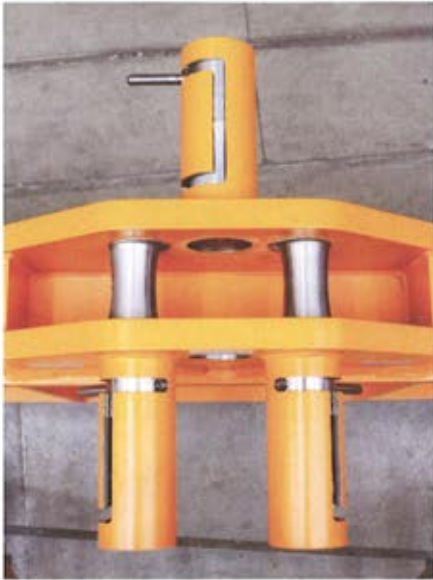
Bild 3 Die Traverse ist wahlweise für die Verwendung von Einfach- und Doppelhaken geeignet.
