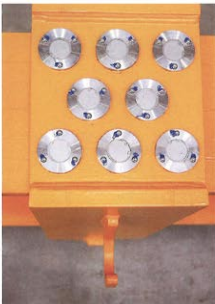
Bild 4 Die gefederten Kugelrollen sorgen dafür, dass sich die Tragrahmen der Traverse variabel verschieben lassen.
