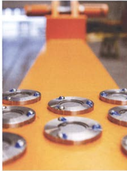
Bild 5 In der Traverse kommen pro Tragrahmen acht gefederte Kugelrollen zum Einsatz. Diese verfügen über einen Bodenflansch und eine Spiralfeder im Inneren, sodass die Kugel bei Belastung einfedern kann und die komplette Last auf dem Gehäuse aufliegt.
