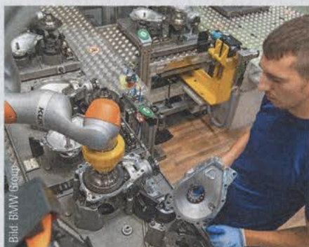
Mensch-Roboter-Kollaboration in der Achsgetriebe- montage im Werk Dingolfing der BMW Group
