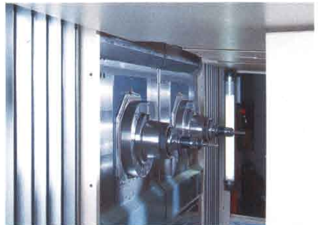
01 Das doppelspindlige Bearbeitungszentrum der Firma Schmid ist mit zwei horizontalen Spindeln ausgestattet; im oberen Bereich sorgt ein Vierpunktlager von Rodriguez im vertikalen Werkzeug-Magazin für die Drehung
