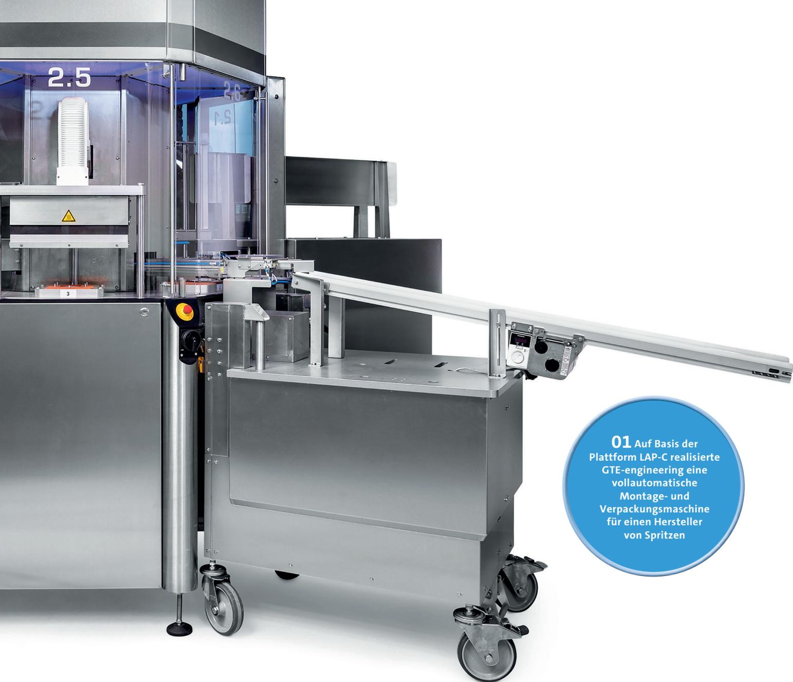
**01** Auf Basis der Plattform LAP-C realisierte GTE-engineering eine vollautomatische Montage- und Verpackungsmaschine für einen Hersteller von Spritzen
